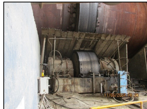
ภาพที่ 2.62 สภาพฉากป้องกันความร้อนระหว่าง Preheater กับคนงานและติดตั้งกรงเหล็ก
