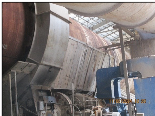
ภาพที่ 2.62 สภาพฉากป้องกันความร้อนระหว่าง Preheater กับคนงานและติดตั้งกรงเหล็ก
